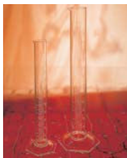
Messzylinder mit Sechskantfuß mit Strichteilung DIN 12 680, ISO 4788
