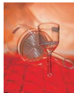
Entonnoirs filtrants à fentes (entonnoirs de Büchner)
