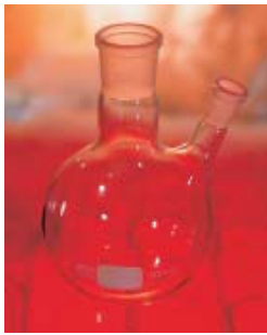
Zweihals-Rundkolben mit Normschliffen, Seitenhals schräg, DIN 12 394
