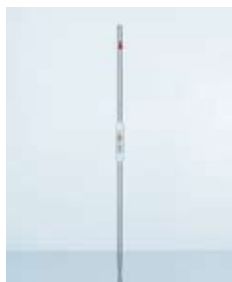
15 sec čekací doba, ze sodnovápenatého skla, třída AS, DIN 12 691, ISO 648
